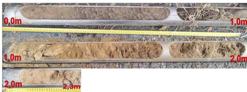
Jádro zarážené sondy ZS3 z hloubkového intervalu 0,0 – 2,3 m
