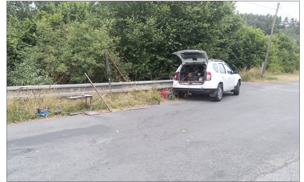
Foto č.2 : Provádění penetrační sondy DP2
